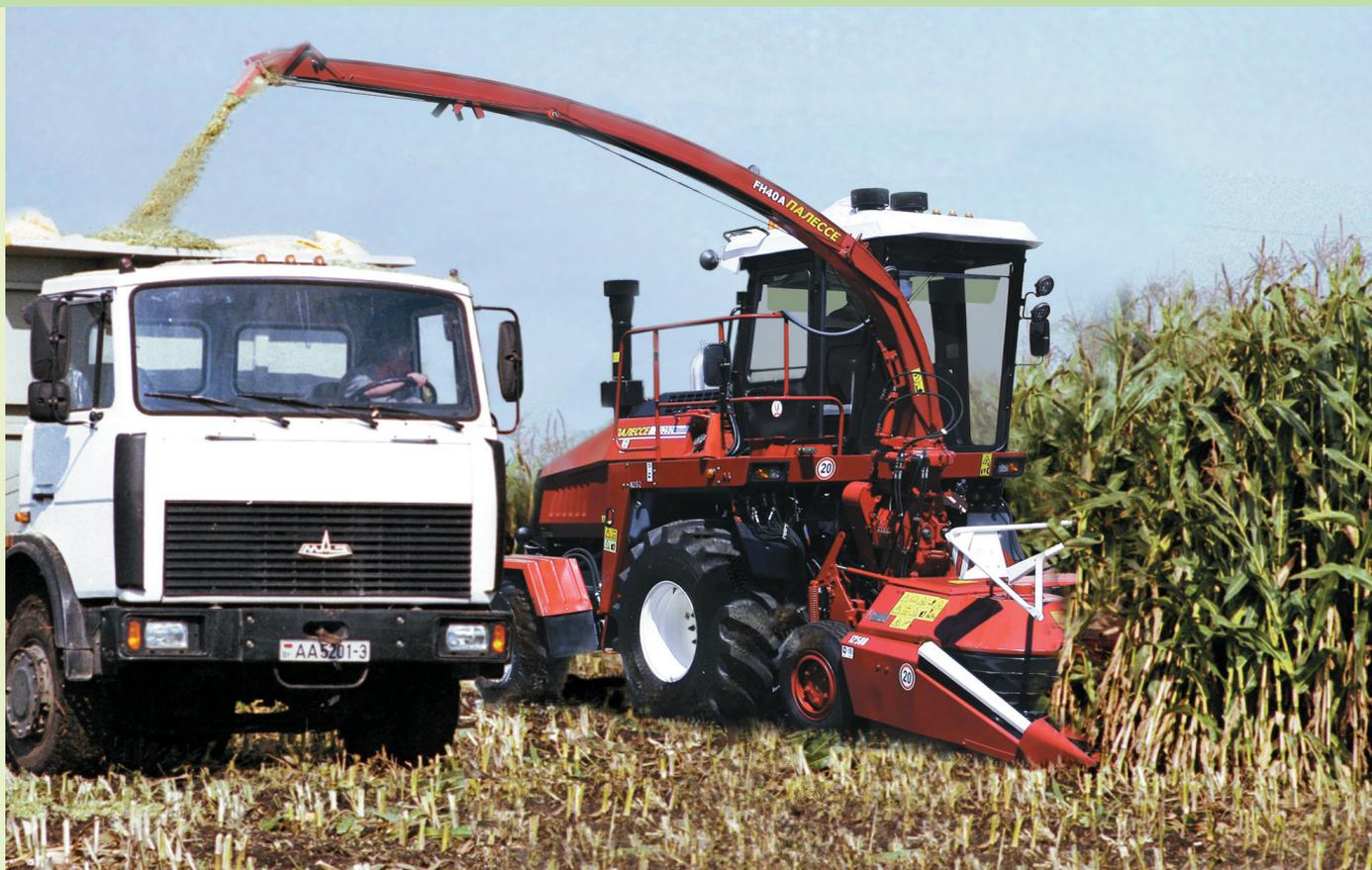
Кормоуборочный комбайн К-Г-6 ПАЛЕССЕ формируется на базе универсального энергосредства (УЭС) и агрегируемого с ним полунавесного комбайна ПАЛЕССЕ FH40. Меняя адаптеры, комбайн выполняет в течение сезона три операции:
