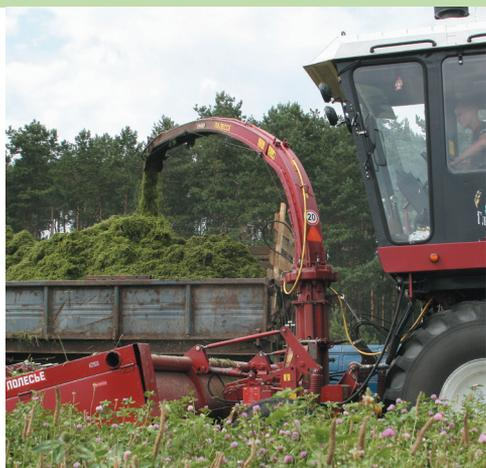
Универсальные энергосредства ПАЛЕССЕ 2U250 и 2U280 с двумя ведущими мостами обеспечивают уборку кормов в экстремальных условиях: на тяжелых почвах, в условиях затяжных дождей на осенней уборке кукурузы восковой спелости. УЭС продолжают стабильно работать даже тогда, когда другие машины просто не могут выйти в поле.
