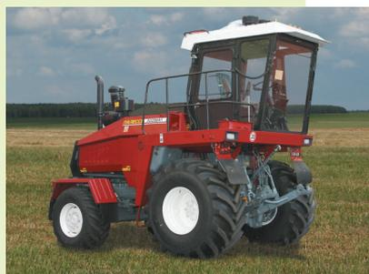
Универсальное энергосредство (УЭС) - самоходная сельскохозяйственная машина, которая отличается способностью передавать до 100% мощности через вал отбора мощности на рабочие (преимущественно вращающиеся) органы агрегируемых с ним навесных машин.
