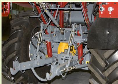
Мощное навесное устройство УЭС дает возможность легко и быстро, не теряя времени на уборке, поднимать и опускать навесные машины при разворотах на краю поля и при переезде на другое поле.
